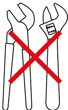
**L'utilisation d'outils type clé à molette ou pince n'est pas recommandée pour l'installation des têtes thermostatiques, au risque d'endommager l'équipement.**
