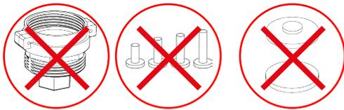
L'adaptateur (B) fourni avec 4 types de piston (A) n'est pas compatible avec les corps de vanne M28x1,5mm tige de pression longue. Le disque avec ergot (E) et le disque (F) ne sont pas nécessaires pour cette configuration
